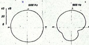
Abb. 5 Polardiagramme zweier Geigen bei 1000 Hz (Stegebene)
