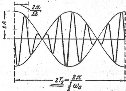
Abb. 18. Schwebung zweier harmonischer Schwingungen gleicher Amplitude.
